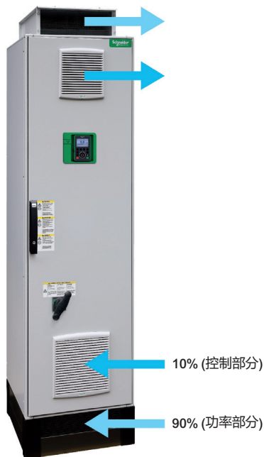
两个隔离的冷却风道
