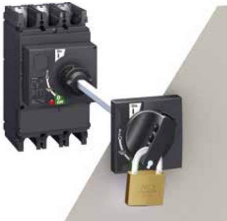
EasyPact EZD400 带有一个扩展的旋转手柄，安装在总机的背面，带有挂锁选项和钥匙。
