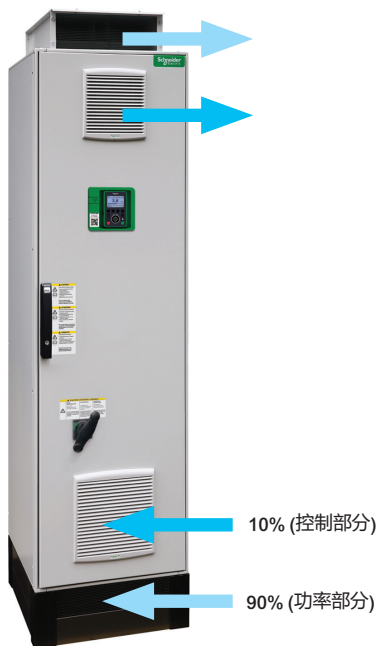
采用两个独立气流的冷却回路
