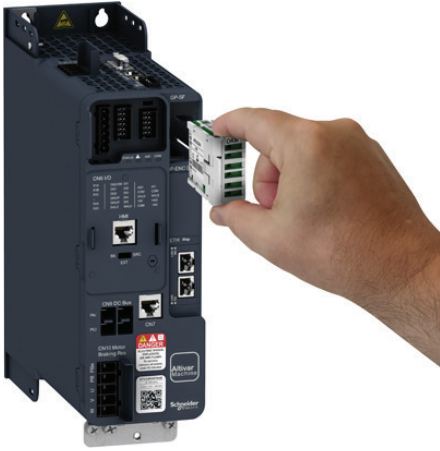
将继电器模块VW3A3204插入以太网式ATV340变频器ATV340U07N4E的GP-SF插槽内。
